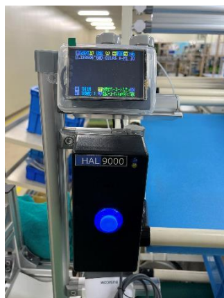
生産設備に取り付けたラズベリーパイ内蔵デバイス(左) 収集データを活用した実生産時間と標準生産時間の比較可視化テスト(右)
